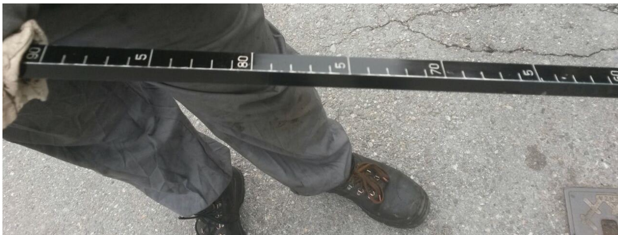
Figura 5.3 - Controllo volumetrico del rifornimento della cisterna mediante l'asta
