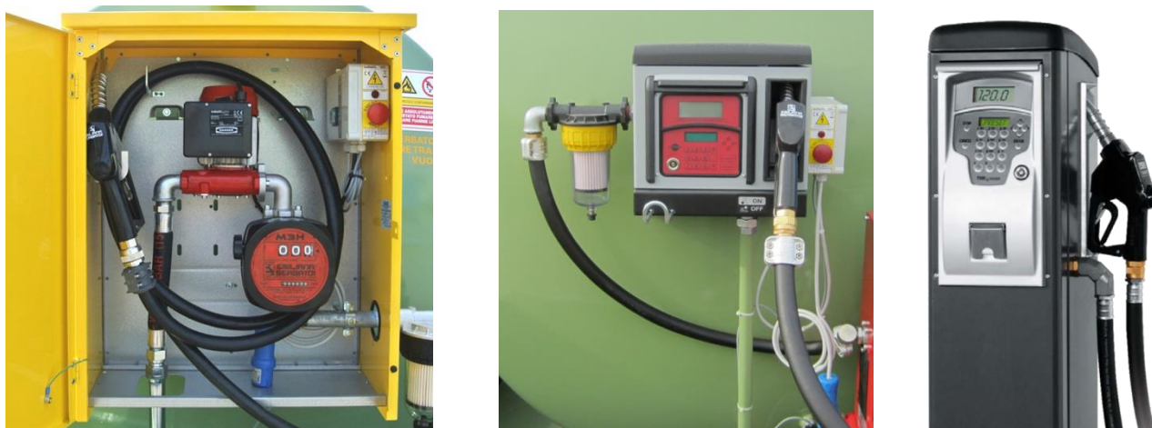
Figura 4.4 - Sistemi di erogazione di diversa complessità: semplice con pompa, contalitri e pistola erogatrice in armadietto; digitale con pistola erogatrice automatica e filtro separatore acqua ispezionabile; colonnina con sistema di controllo elettronico (fonti: Emiliana Serbatoi e Piusi Pompe).
